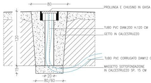
PARTICOLARE ROTATORIA SEZIONE A-A
